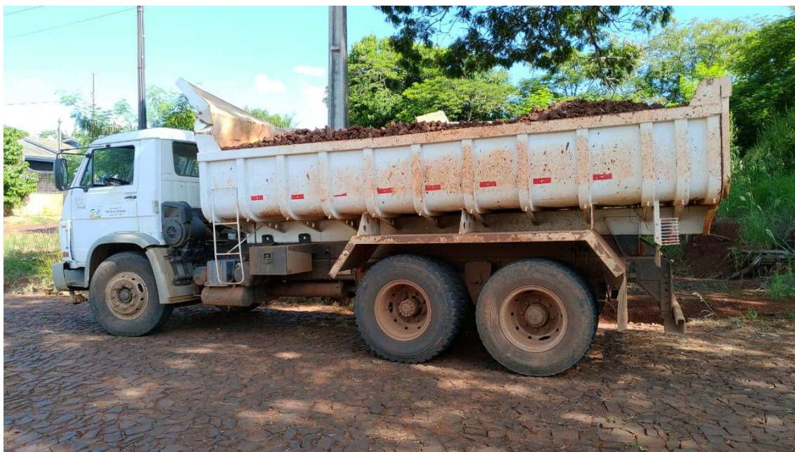
Figura 11 – Caminhão utilizado para Teste de Carga
